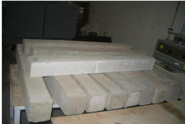
Figure II.1. Poutrelles destinées aux essais
