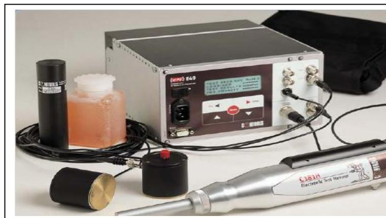
Figure I.1. Appareillage ultrasonique utilisé
