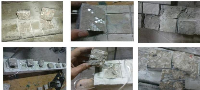
Figure II.6. Photo de rupture lors des essais destructifs (arrachement)
