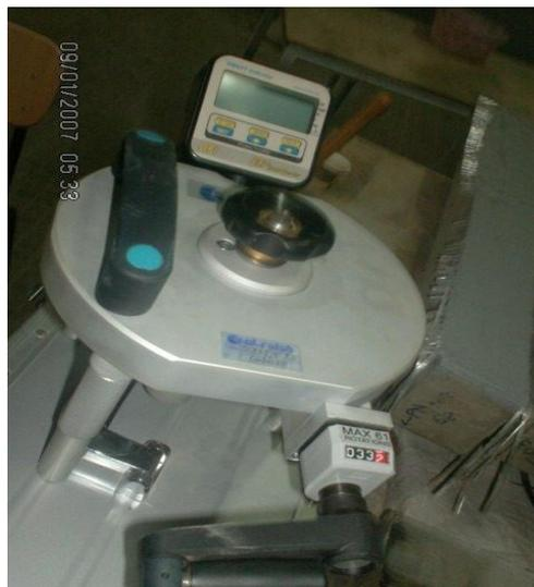
Figure I.6. Photo du dynamomètre de traction utilisé
