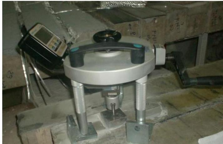
Figure II.5. Photo de l'opération des essais destructifs (arrachement)
