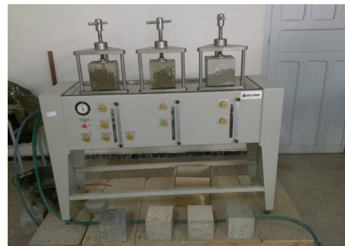
Figure II.21 : Essais de perméabilité à l'eau
