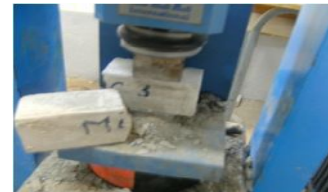
Figure II.17 : Presse pour les essais de flexion et de compression sur éprouvettes 4 \times 4 \times 16 \text{ cm} .
