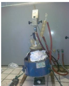
Figure I. 15 Dispositif de préparation de la mono-glycéride
