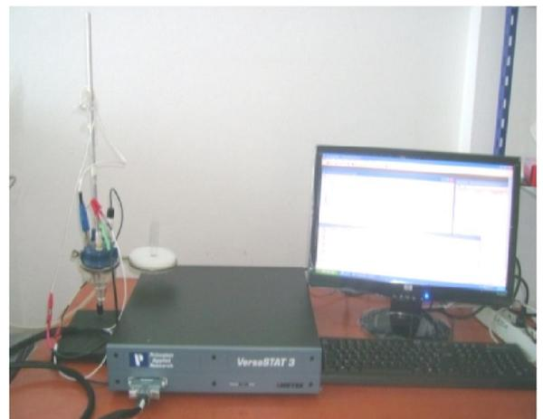
**Figure6 :** Montage de test de corrosion
