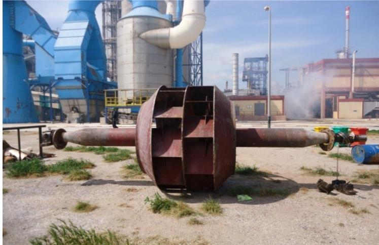
**Figure 2.4. Photo du rotor défectueux du MK17**
