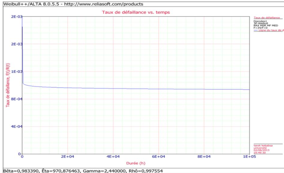
Figure 1.20. Le taux de défaillance  $\lambda(t)$  en fonction du temps (105J)
